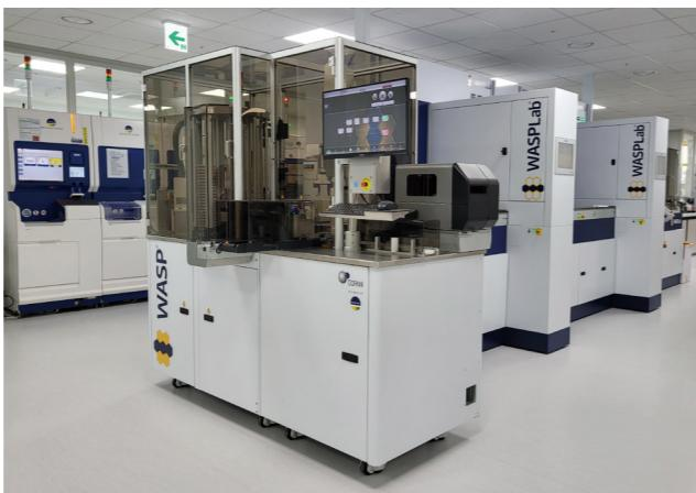
Fig. 1. 미생물검사실 TLA 시스템 (WASPLab<sup>®</sup>)
